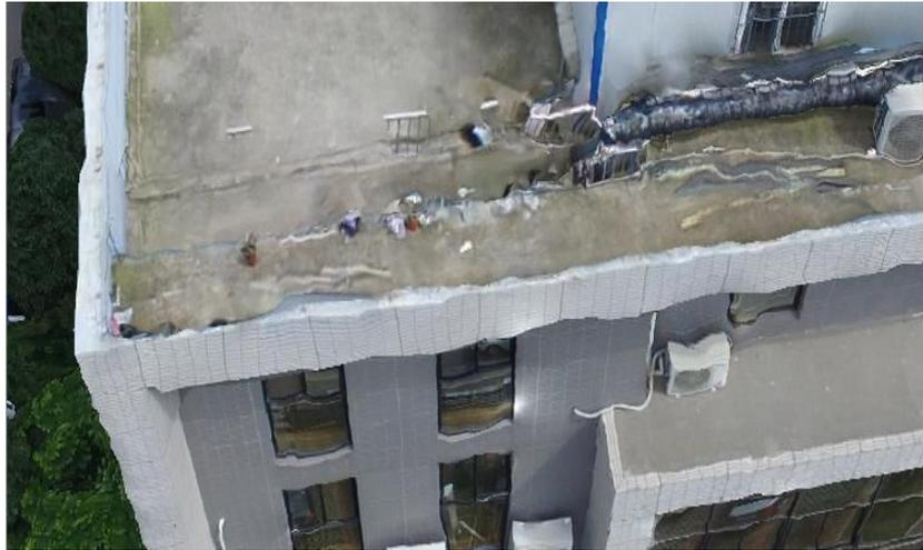
2、将基准点定位到房屋角点上，此时基准面便在房屋所在的面上。这就和基于倾斜影像建模的测图效果一样，只不过基于倾斜影像的建模是通过测图得到测点的坐标，而将基准点定位到该点获取该点的基准面，在这里，将基准点定位在 OSG 模型上某点便直接获取了该点基准面。
